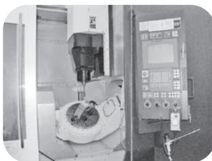
5軸制御マシニングセンター D500 牧野フライス製作所製
